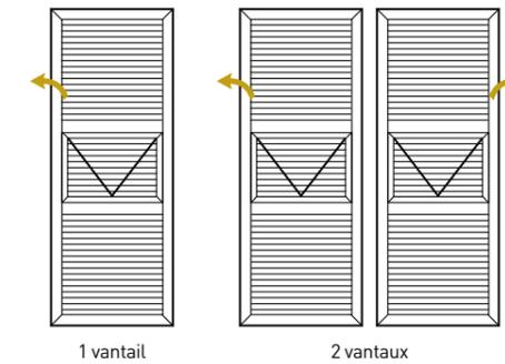
Particulièrement répandu dans le sud-est de la France, le volet niçois comprend une partie à projection appelée le partisol. Celui-ci permet de moduler l'entrée d'air et de lumière.
